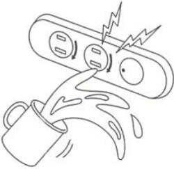
電球割れによるけがや、感電する恐れ、また漏電による火災の恐れがあります。
