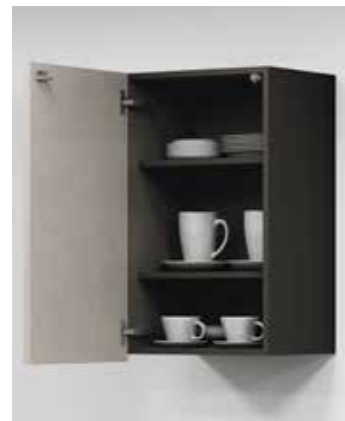
片開き W150・300・450 D 350 H 300~1200(150ピッチ) 可動棚 ※レンジフード横の場合は不燃仕様
