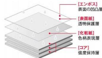
「高圧メラミン化粧板」は、メラミン樹脂、フェノール樹脂をそれぞれ印刷紙・クラフト紙に含浸させ乾燥させた含浸紙を何枚も重ね合わせて、高温 (150℃)、高圧 (約100kg/cm) 下で積層形成したプラスチック板です。表面の硬さや汚染性に優れており、表面の硬さについては鉛筆の芯に例えると8H~9Hの硬度をもっています。傷がつきにくく、お手入れのしやすい素材としてキッチンの扉に採用いたしました。
